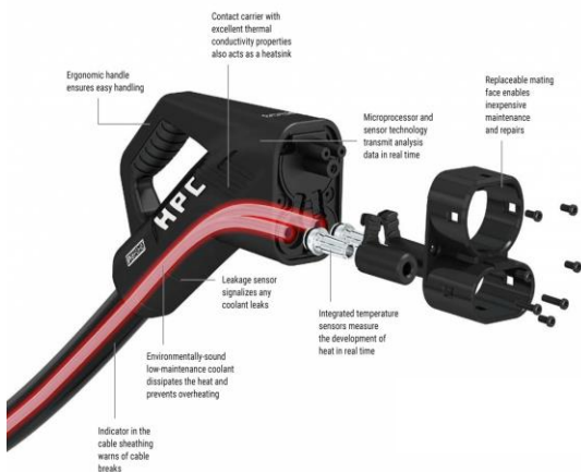
그림7 초급속 충전기 냉각케이블 구조
