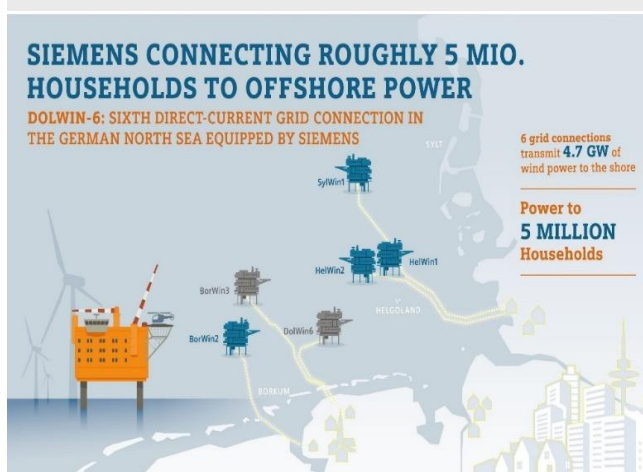
그림30 Siemens Energy의 해상 풍력 발전소 - HVDC 컨버터 스테이션 - 육상 전력망 연결 조감도
