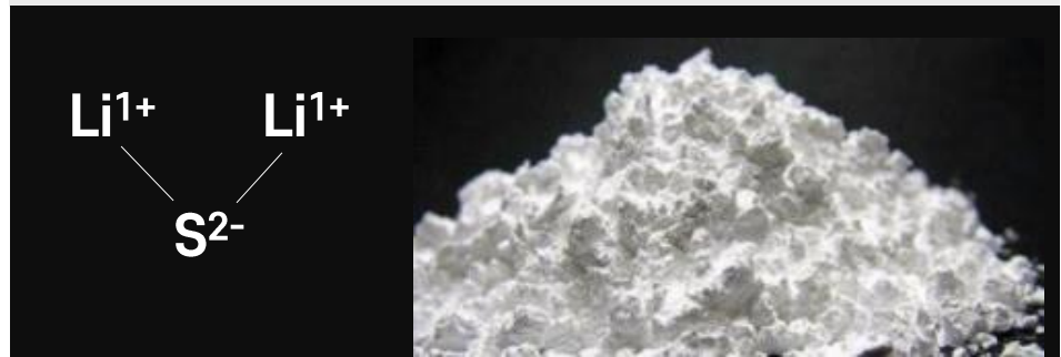
그림17 황화리튬 구조 및 형상
